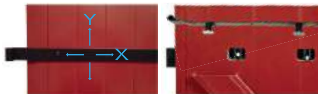
PENTURE RÉGLABLE Système invisible INVIRENOV® +10mm à - 10mm sur l'axe horizontal X +8mm à -8mm sur l'axe verticale Y Adaptable sur Barres et Pentures
